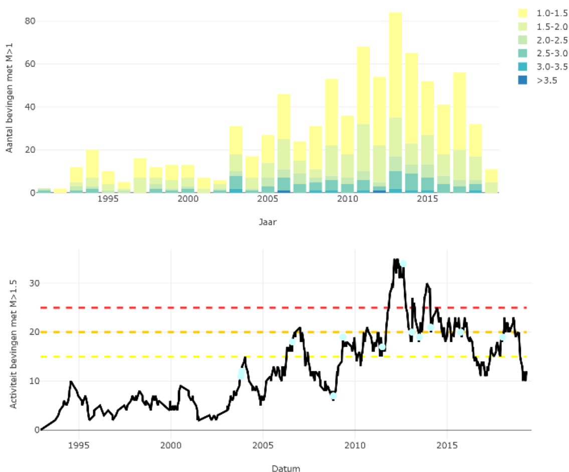
Figuur A-1. Boven: Overzicht van het aantal bevingen per jaar, ingedeeld naar sterkte van de bevingen. Onder: Overzicht van het aantal bevingen met een magnitude groter dan of gelijk aan ML = 1,5 dat in de voorgaande twaalf maanden geregistreerd is ('activity rate').
